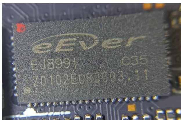
Imagem 4 – Componente da PCBA – Posição U16
